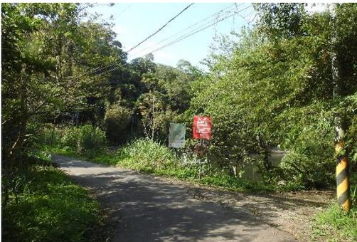
圖 2、施工便道優先使用既有道路，若遇兩側既有原生植被樹冠較大且可能影響工程，應於進行修枝，避免大樹結構受損。
